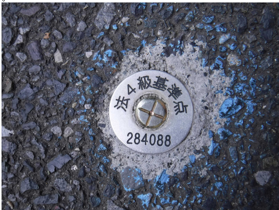
<道路地内に設置された実際の4級基準点>
