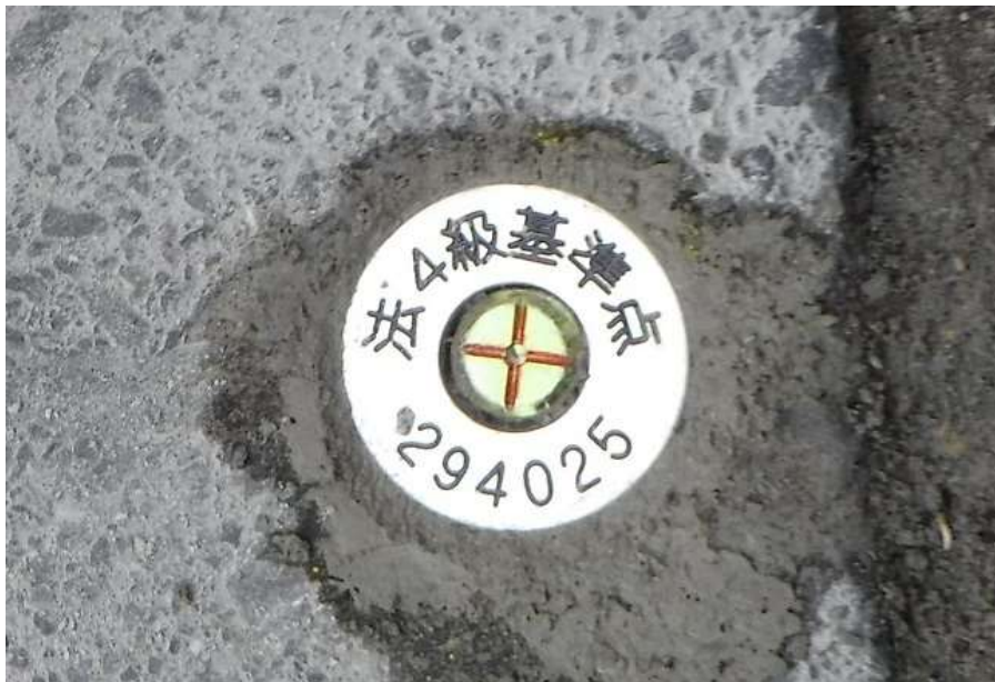
<道路地内に設置された実際の4級基準点>
