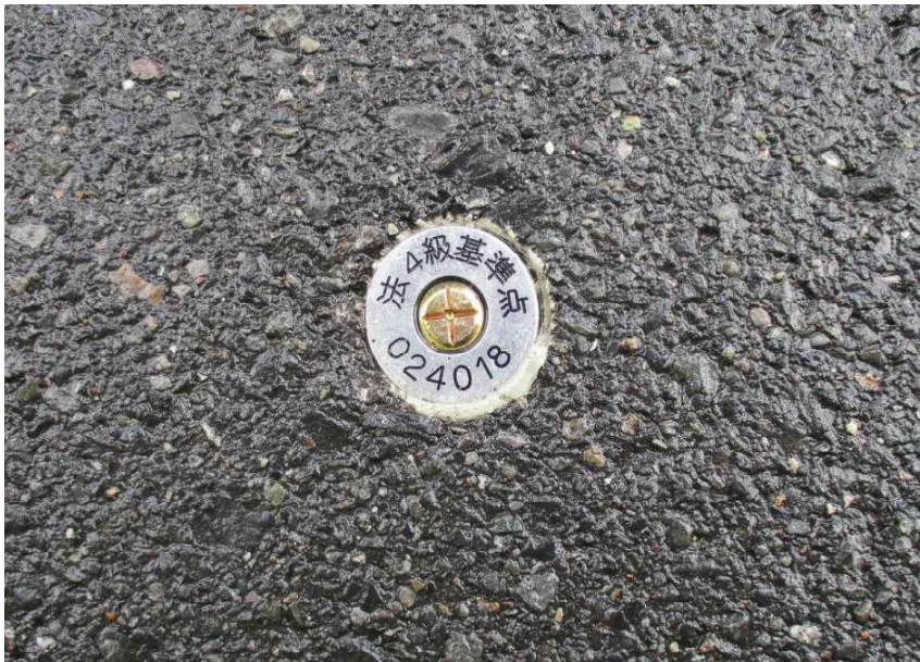
<道路地内に設置された4級基準点の例>
