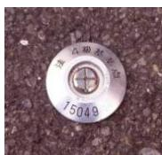
基準点測量において、法務局が設置する4級基準点（金属鉢）サンプル
