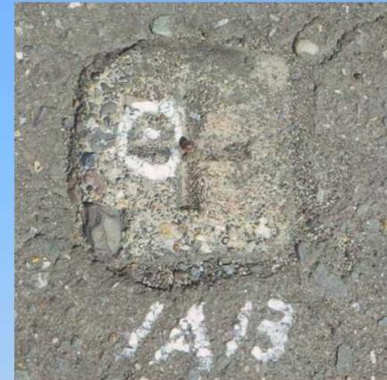
筆界点に**金属プレート等の標識**を設置します。
