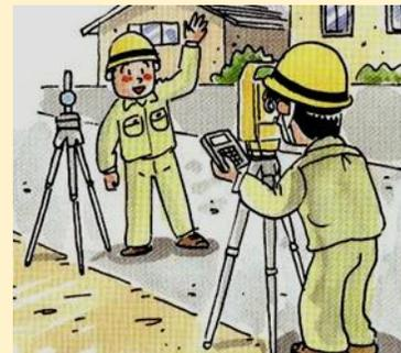
・①で設置された基準多角点に測量機器を据え付け、③の一筆地調査で確認した境界までの距離や角度を測定します。
