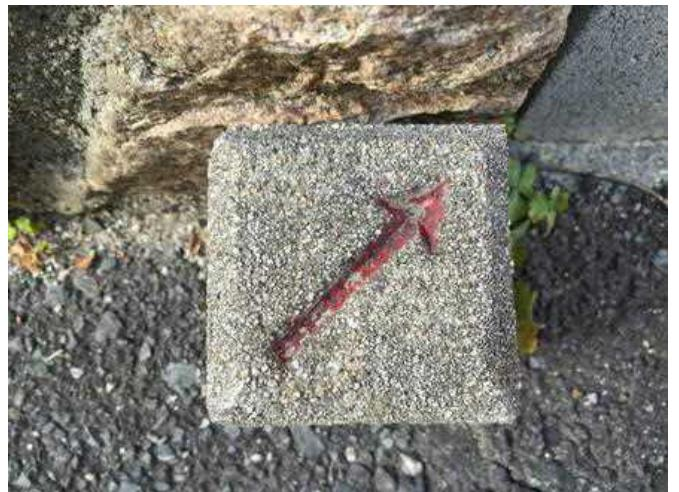
写真のように既に設置されている境界標等を調査して測量します。
