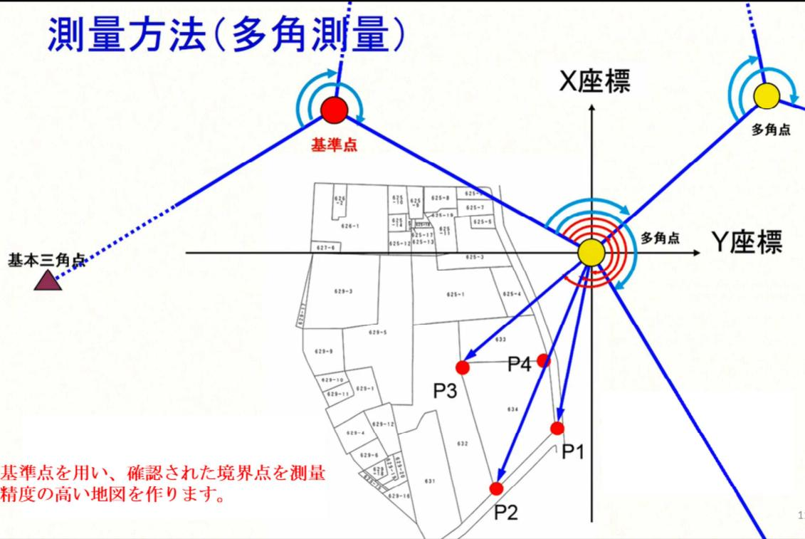
そして、事前に設置した測量基準点を用い、確認された境界点を測量して、精度の高い地図を作成し、登記所（法務局）に備え付けます。
